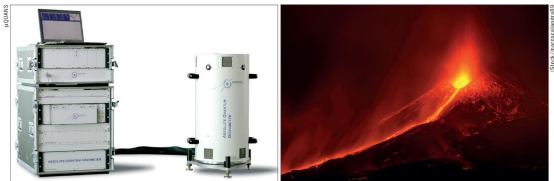
图2 在意大利埃特纳（Mount Etna）火山进行重力测量的量子重力仪
